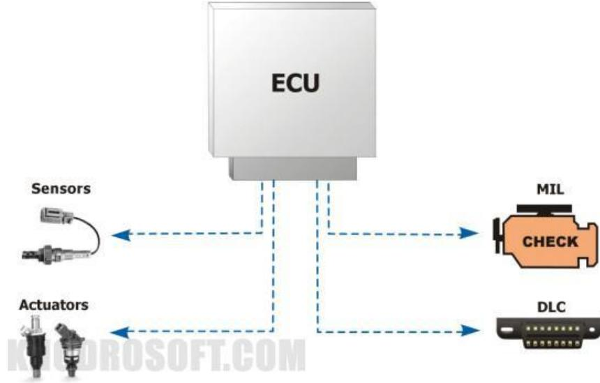
یک وسیله نقلیه مدرن می تواند صدها نوع از پارامترهای هشدار را از طریق DLC (وسیله اتصال عیب یابی) با استفاده از ابزار اسکن (Scan tools) پشتیبانی کند.
